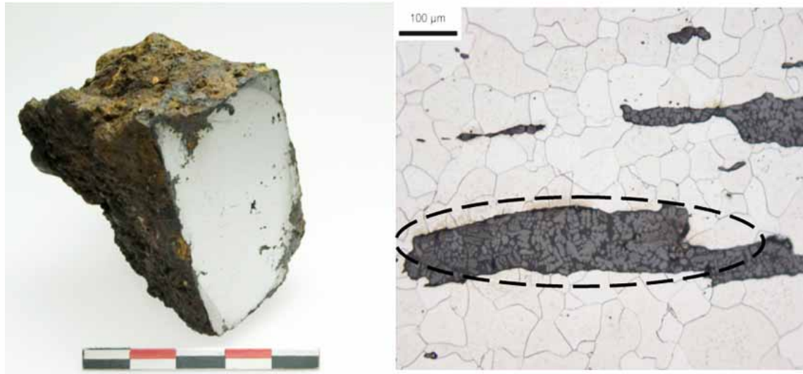
A gauche : Objet en fer archéologique retrouvé sur un site des Pyrénées A droite : Inclusion piégée dans la matrice métallique de l'objet
